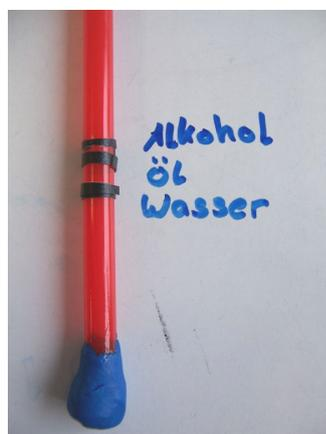
Als Nullmarke setzt man die Eintauchtiefe der Plastikhülle in Wasser. Dann taucht man das Aräometer ins Salzwasser. Wir wissen: Salzwasser ist schwerer als Leitungswasser, also ist seine Auftriebskraft größer. Gibt man dieselbe Plastikhülle in diese Lösung, guckt sie weiter heraus.
