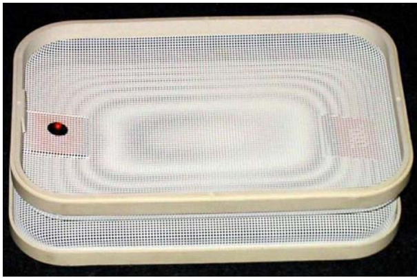
Abb. 6. Die Form dieser Lautsprecherabdeckungen entspricht in übertriebenem Maße der Form einer Isolierscheibe mit nach innen gewölbten Scheiben. Hier wird das Höhenlinienbild der Krümmung mithilfe eines Moiré-Phänomens sichtbar.
