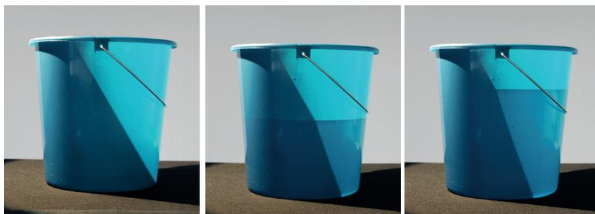
2 | Eimerversuch, Teil 2: Die Schattenkante knickt an der Wasseroberfläche nach unten ab, sodass mit steigendem Wasserspiegel ein zunehmender Teil des Eimerbodens beleuchtet wird.
