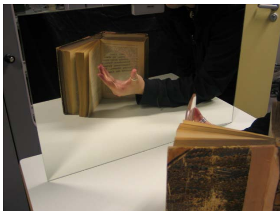
Abb. 2: Das Buch – Helmholtz' „Handbuch für physiologische Optik“ – ist natürlich nicht in Spiegelschrift geschrieben. Wir erblicken vielmehr im Querschnitt einer gespiegelten Linse das vergrößerte Schriftbild einer gespiegelten Buchseite. Das heißt insbesondere: auch die gespiegelte Linse funktioniert als Linse.
