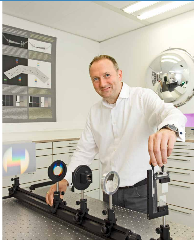
Will Schüler*innen für den Physikunterricht begeistern: Prof. Dr. Johannes Grebe-Ellis mit einem neuen Experiment zur simultanen Erzeugung komplementärer Spektren.
