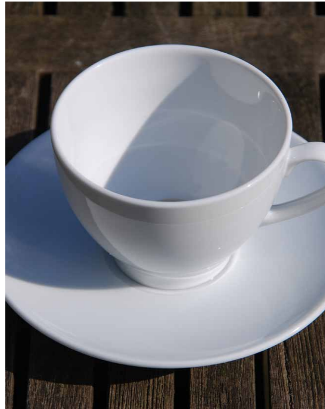
Der Tassenversuch: Hebung und Brechung zugleich. Bei gleichbleibenden Blick- und Beleuchtungswinkeln wird Wasser in eine Tasse gefüllt. Mit zunehmendem Wasserstand erscheint der Tassenboden optisch gehoben: Eine vorher verborgene Münze wird sichtbar (Hebung). Gleichzeitig wird der Tassenboden, der ohne Wasser im Schatten lag, mit steigendem Wasserstand zunehmend beleuchtet: Wie der Verlauf der Schattengrenze an der Tassenwand zeigt, knickt die Beleuchtungsrichtung an der Wasseroberfläche nach unten ab (Brechung).
