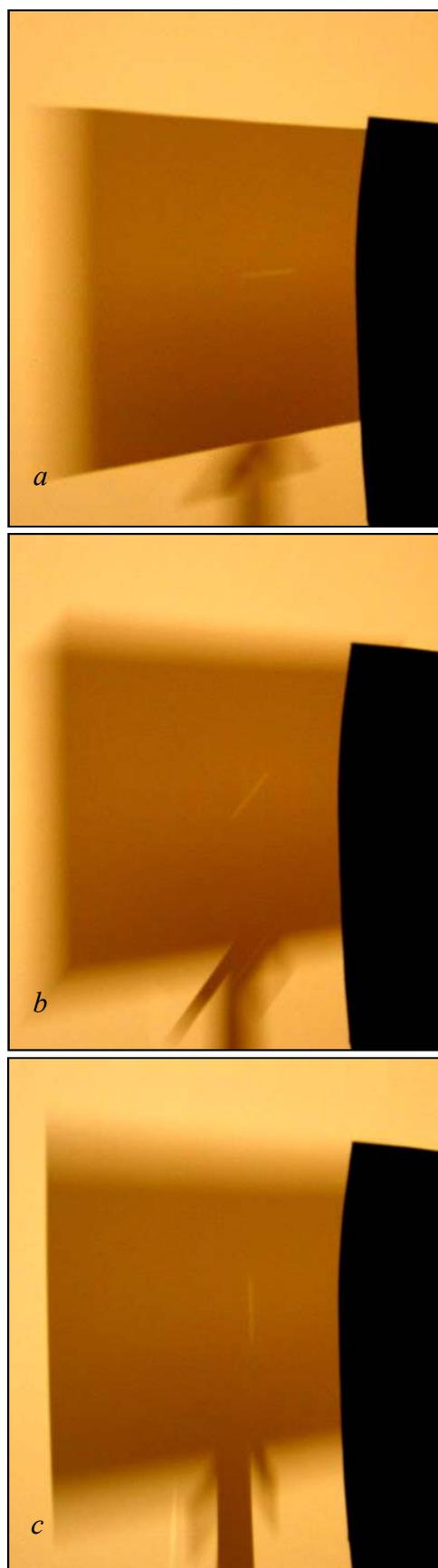
Abb. 6, a–c: Drehung des Schattenbildes bei Drehung der Stableuchte: Das Schattenbild ist das Lochkamerabild der Stableuchte.
