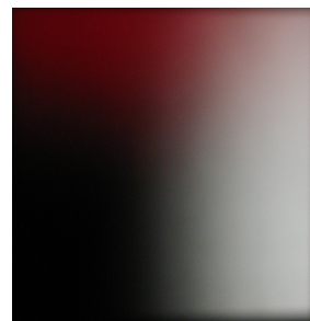
Abb. 1: Projektion von zwei 90° zueinander gedrehten Graukeilen mit rotem und weißem Licht
